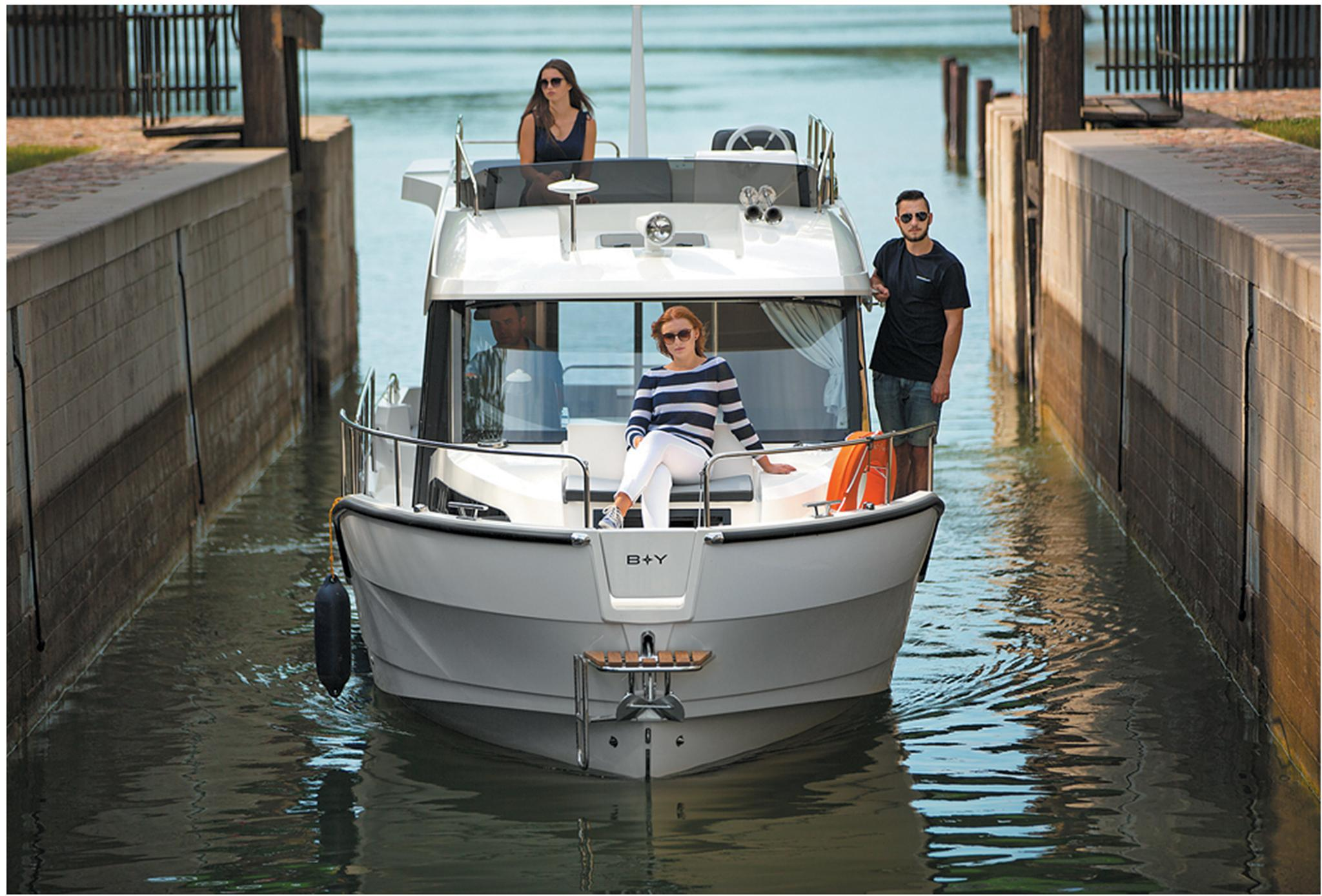
**ODKRYWANIE NIEDOSTĘPNYCH WÓD** Niemal wszystkie akweny staną się dostępne dzięki: małemu zanurzeniu, optymalnej szerokości łodzi - 3m (wąskie śluzy, przewężenia kanałów, wózki pochylni), ograniczonej wysokości nad linią wodną (3,5 m; 2,9 m po położeniu maszcziku sygnalowego czy zaledwie 2,55 m po zdemontowaniu relingu i owiewki na dachu oraz położeniu maszcziku [niskie mosty do pokonania!]).
